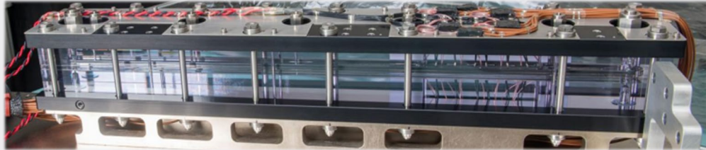
Flow boiling module
